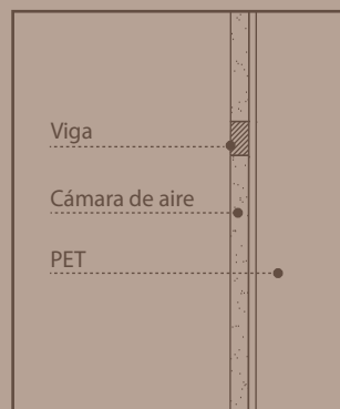
(3) Instalar las vigas con una distancia de 60 cm en la pared y 30 cm en el caso del techo. Pegar la plancha sobre las vigas.
